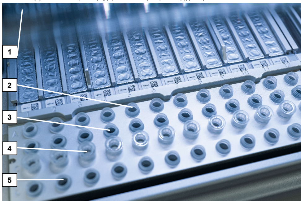
Фигура 5. Работна маса на апарата EZ2 Connect MDx. (1) Нагревателен блок с епруветки (ST) от 2 ml, заредени в касетите с реактиви (RCV) за лизиране. (2) Епруветки за аликвотни части (ST) (2 ml), заредени на ред А. (3) Епруветка (ET) (1,5 ml), съдържаща носеща РНК (CARRIER) и вътрешна контрола (Internal Control, IC) (ако се използва) в елуиращ буфер (AVE), заредена на ред В. (4) Държачи за накрайници за еднократна употреба (DTH), съдържащи филтърни накрайници за еднократна употреба (DFT), заредени на ред С. (5) Епруветки за елуиране (ET) (1,5 ml), заредени на ред D.
