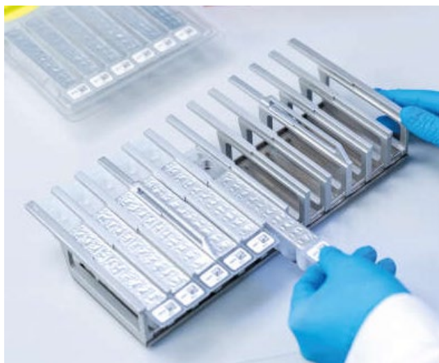
Фигура 3. Статив за касети с реактиви. Самият статив за касети е обозначен със стрелка, която указва посоката, в която трябва да се заредят касетите с реактиви (RCV).
