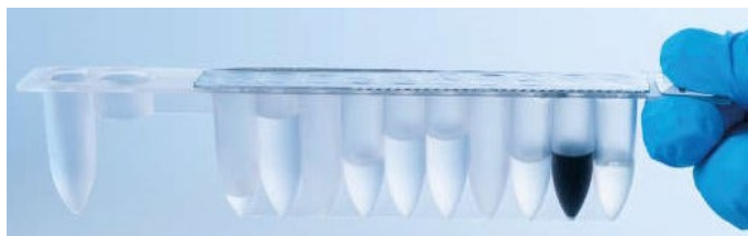
Εικόνα 8. Φύσιγγα αντιδραστηρίων (RCV). Μια σφραγισμένη, προγεμισμένη φύσιγγα αντιδραστηρίων για το EZ1 DSP Virus Kit.
