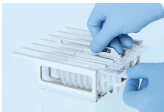
Εικόνα 9. Φόρτωση της βάσης στήριξης φυσιγγων αντιδραστηρίων. Η βάση στήριξης φυσιγγων επισημαίνεται με ένα βέλος που υποδεικνύει την κατεύθυνση στην οποία πρέπει να φορτωθούν οι φύσιγγες αντιδραστηρίων (RCV).
