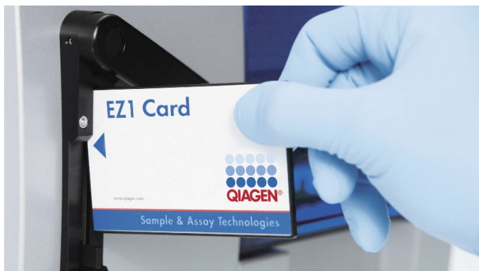
Εικόνα 6. Ευκολία ρύθμισης πρωτοκόλλου με τις κάρτες EZ1 DSP Cards. Εισαγωγή μιας κάρτας EZ1 Card, εκ των προτέρων προγραμματισμένης με το πρωτόκολλο, στο όργανο EZ1.
