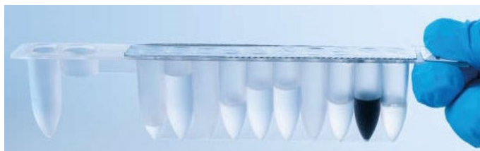
Εικόνα 2. Φύσιγγα αντιδραστηρίων (RCV). Σφραγισμένη, προγεμισμένη φύσιγγα αντιδραστηρίων (RCV) για το EZ1 DSP Virus Kit.
