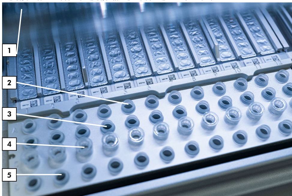
Εικόνα 5. Τραπέζι εργασίας του οργάνου EZ2 Connect MDx. (1) Θερμικό μπλοκ με σωληνάρια των 2 ml (ST) φορτωμένο στις φύσιγγες αντιδραστηρίων (RCV) για λύση. (2) Σωληνάρια δείγματος (ST) (2 ml) φορτωμένα στη σειρά A. (3) Σωληνάριο (ET) (1,5 ml) που περιέχει φορέα RNA (CARRIER) και εσωτερικό μάρτυρα (Internal Control, IC) (εάν χρησιμοποιείται) σε ρυθμιστικό διάλυμα έκλυσης (AVE), φορτωμένο στη σειρά B. (4) Υποδοχείς αναλώσιμων ρυγχών (DTH) που περιέχουν αναλώσιμα ρύγχη φίλτρου (DFT) φορτωμένα στη σειρά C. (5) Σωληνάρια έκλυσης (ET) (1,5 ml) φορτωμένα στη σειρά D.
