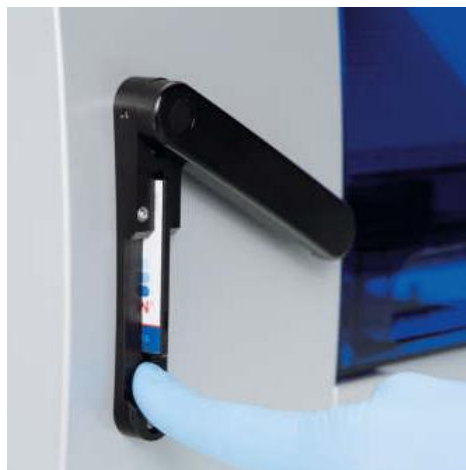
Εικόνα 7. Πλήρης εισαγωγή κάρτας στην υποδοχή κάρτας EZ1 Card.
