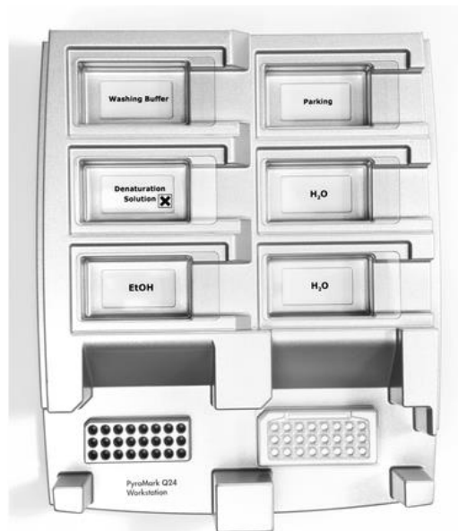
Εικόνα 3. Τοποθέτηση της πλάκας (ή των ταινιών) PCR και της πλάκας PyroMark Q24 στον σταθμό εργασίας υπό κενό.
