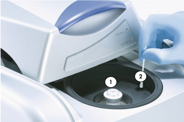
Intern vy av Rotor-Gene Q-kammaren
