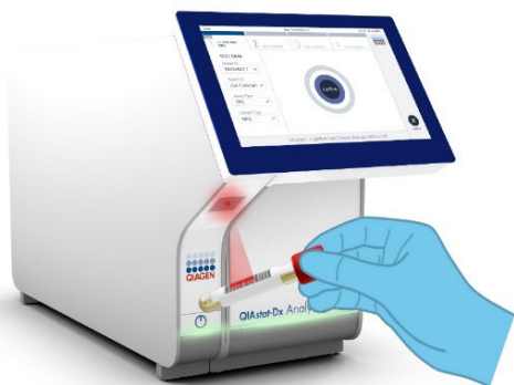
Slika 10. Skeniranje bar-koda ID-a uzorka.
