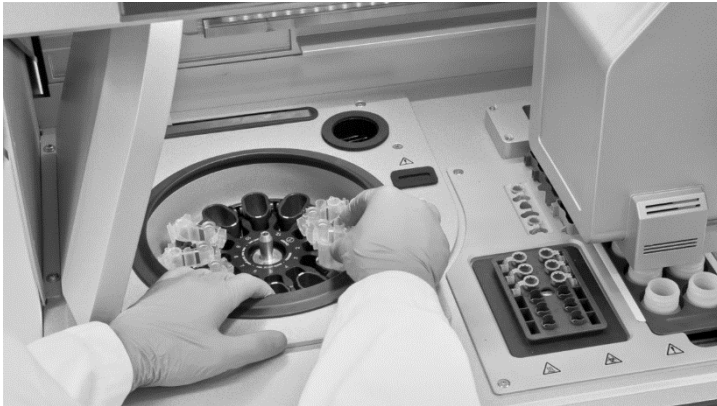
Kuva 21: QIAcube Connect MDx -sentrifugin täyttäminen. Aseta kootut roottoriadapterit sentrifugin koteloihin.
