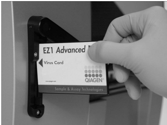
Afbeelding 1. Eenvoudige opstelling van het protocol met behulp van EZ1 DSP Cards. Invoegen van een EZ1 Card, vooraf geprogrammeerd met het protocol, in het EZ1-instrument.
