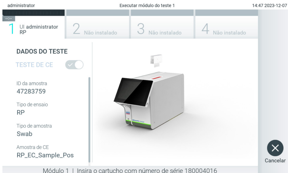
Figura 97. Inserção do cartucho de ensaio QIAstat-Dx no QIAstat-Dx Analyzer 2.0.
