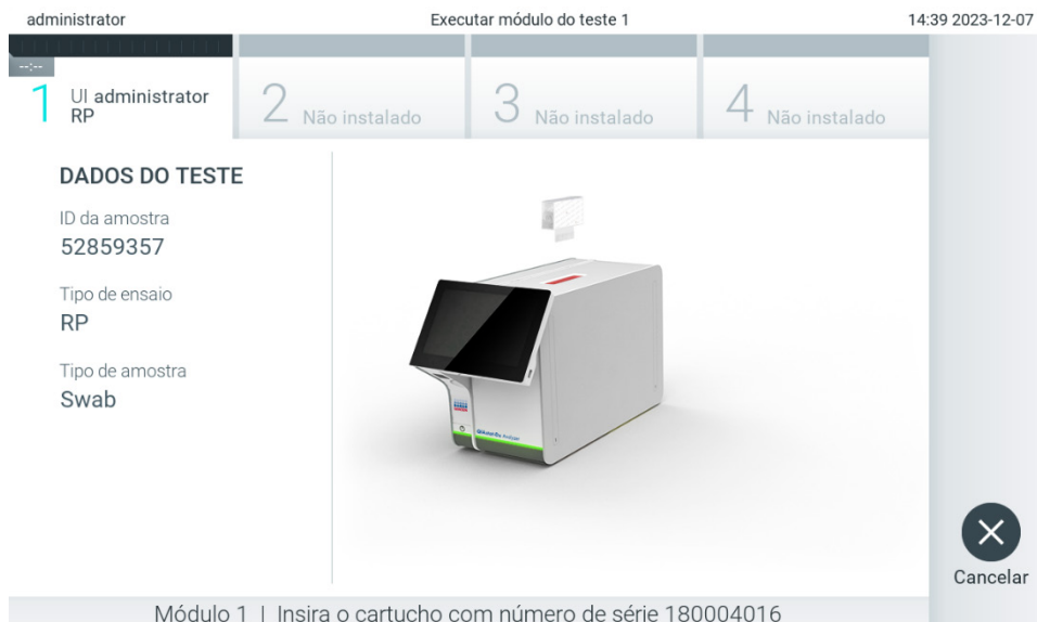
Figura 27. Inserção do cartucho de ensaio QIAstat-Dx no QIAstat-Dx Analyzer 2.0.
