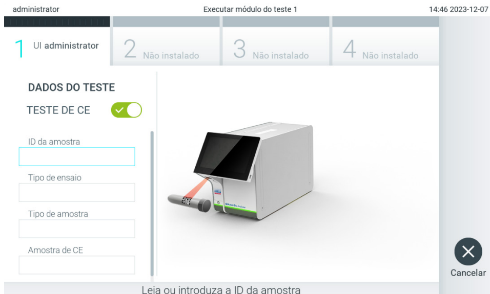
Figura 92. Ligar o botão de alternância EC Test (Teste de CE) para permitir a execução de um teste de CE.
