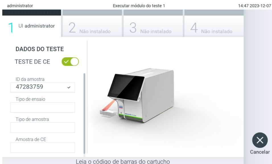
Figura 93. Digitalização do código de barras do cartucho de ensaio QIAstat-Dx.
