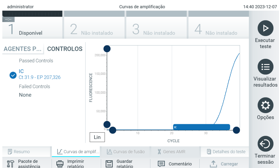
Figura 35. Ecrã Amplification Curves (Curvas de amplificação) (separador CONTROLS [CONTROLOS]) a apresentar os controlos internos.
