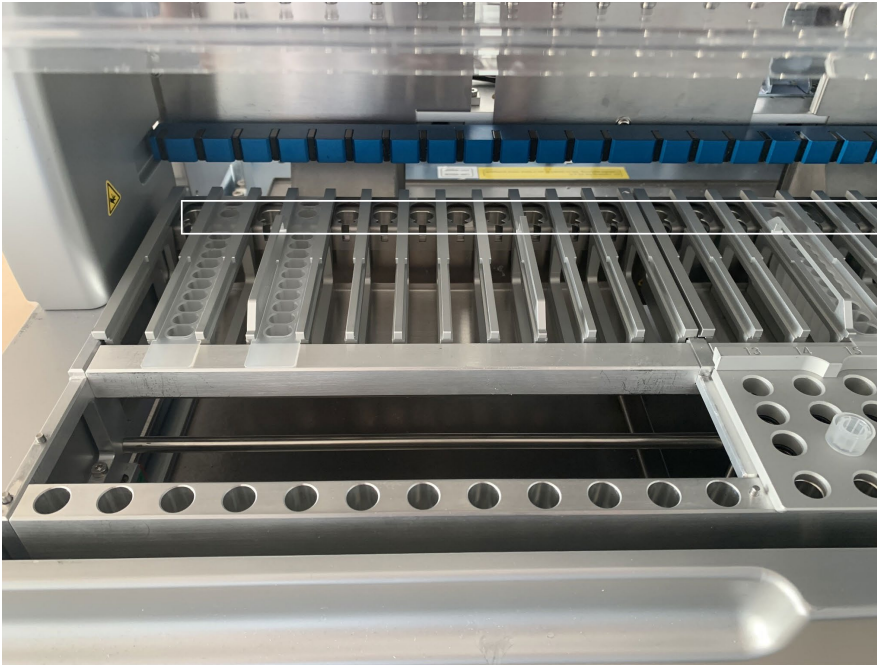
Kuva 17. Lämmitettävät paikat kasettelineessä (merkitty valkoisella kehyksellä).
