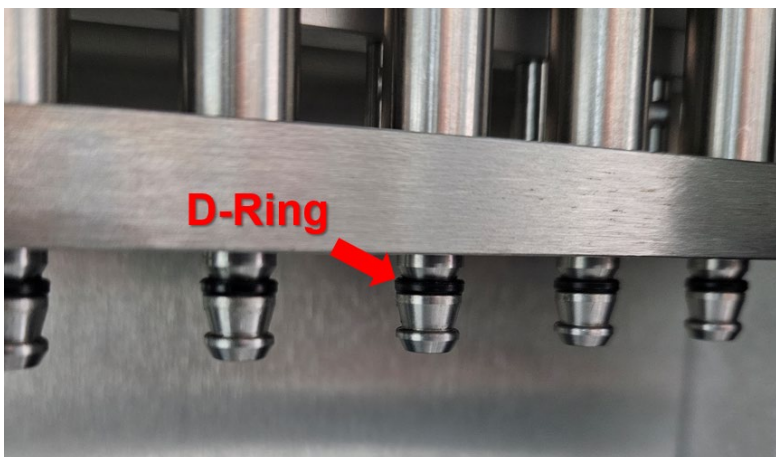
Kuva 177. Kärkisovitin, D-rengas korostettu.
