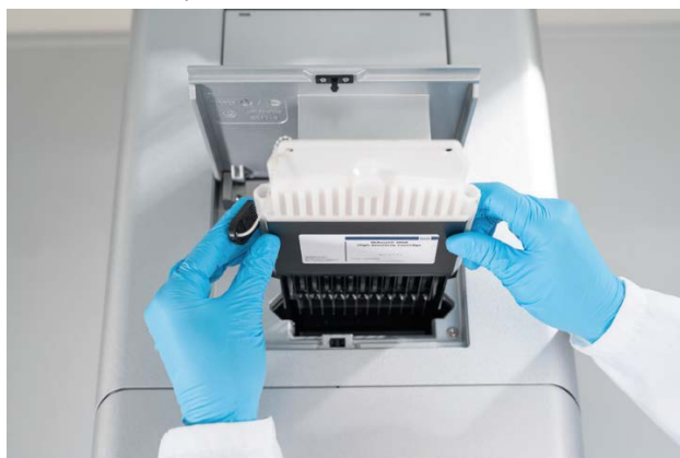
Figura 9. Installazione della QIAxcel Gel Cartridge.
