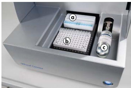
Figura 4. Posizione del portavassoio per tamponi (a), portapiastre per campioni (b) e porta N 2 : (c).
