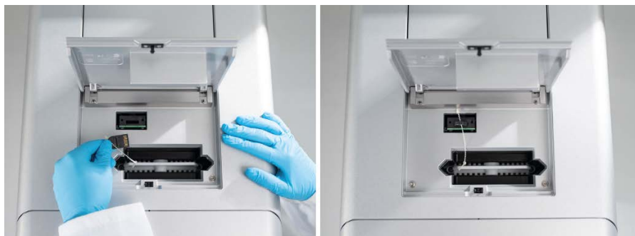
Figura 10. Inserimento della smart key.
