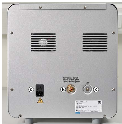
Figura 5. Connettore di alimentazione (a), N 2 esterno (b) e porta USB (c).
