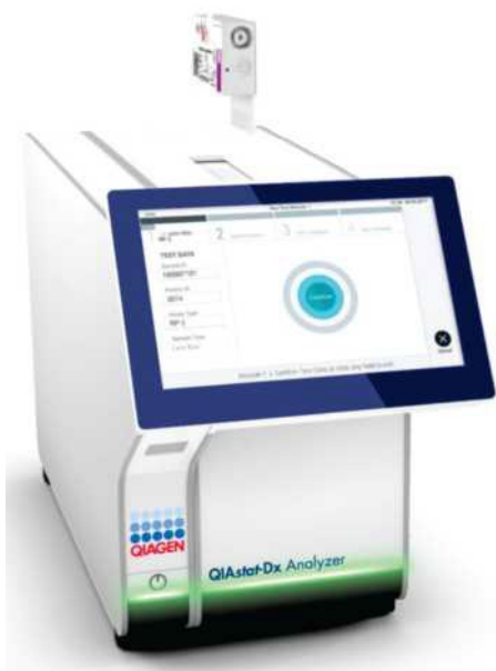
13-сурет. QIAstat-Dx Analyzer 1.0 панелін QIAstat-Dx Gastrointestinal Panel 2 картриджіне орнату.
