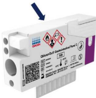
3-сурет. Үлгі туралы ақпаратты QIAstat-Dx Gastrointestinal Panel 2 картридждің жоғарғы жағына орналастыру.
