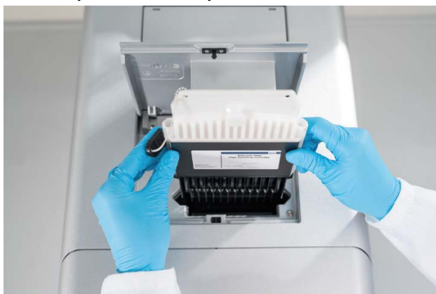
Ryc. 9. Instalacja kasety QIAxcel Gel Cartridge.
