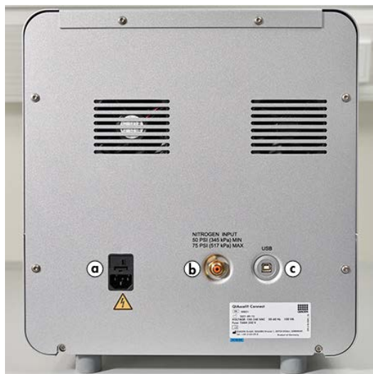
Ryc. 5. Złącze zasilania (a), port zewnętrznej źródła N2 (b) i port USB (c).
