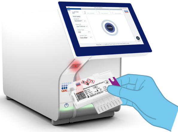
Joonis 11. Kasseti QIAstat-Dx Gastrointestinal Panel 2 Cartridge vöökoodi skannimine.
