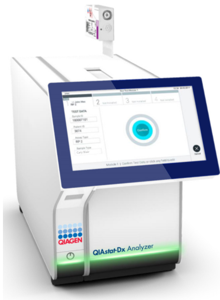
Joonis 13. Kasseti QIAstat-Dx Gastrointestinal Panel 2 Cartridge sisestamine analüsaatorisse QIAstat-Dx Analyzer 1.0 või analüsaatorisse QIAstat-Dx Analyzer 2.0.
