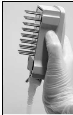
Abbildung 10. Der Saugkopf um mehr als 90° in die Senkrechte geschwenkt.
