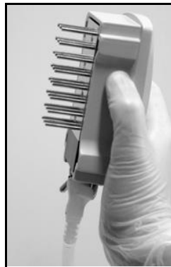
Abbildung 6. Der Saugkopf um mehr als 90° in die Senkrechte geschwenkt.
