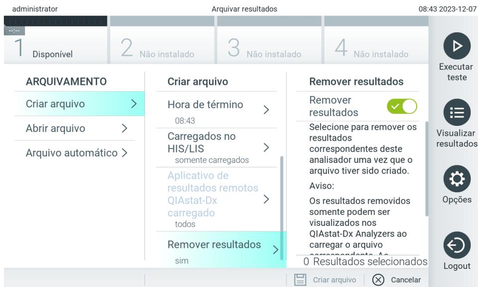
Figura 81. Tela da opção Remove Results (Remover resultados).
