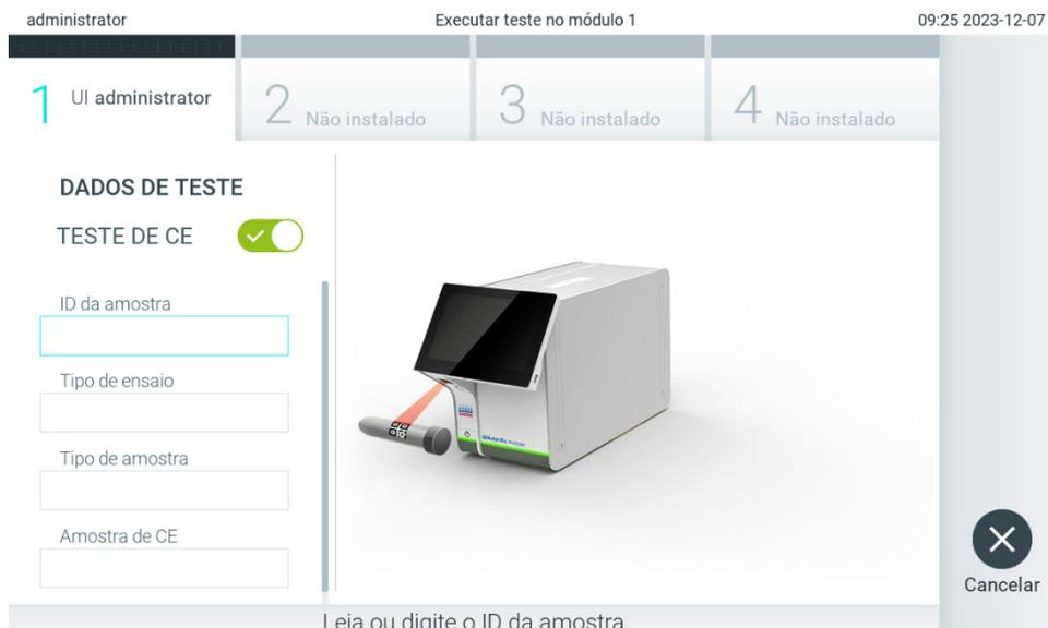
Figura 92. Ativando o botão de alternância EC Test (Teste de EC) para habilitar um teste de EC (CE).
