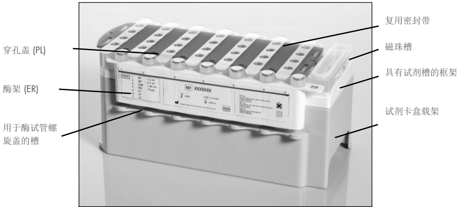
图 2. QIAasymphony 试剂卡盒 (RC)。 试剂卡盒 (RC) 包含执行方案所需的所有试剂。
