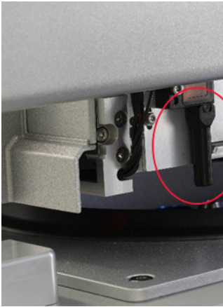
Colimador de haz negro (véase el círculo rojo) del sensor ultrasónico.
