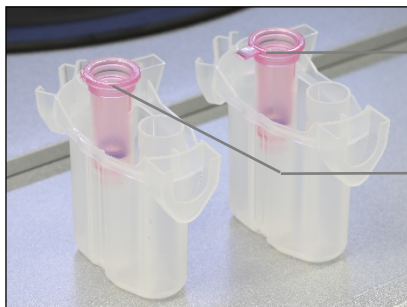
Comparación entre tapas de columna retiradas de forma correcta e incorrecta.
