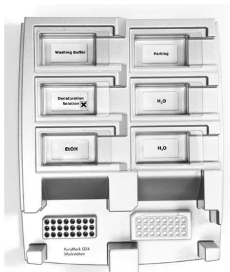
Figura 2. Pozitionarea placutei PCR (sau benzilor) si placutei PyroMark Q24 pe statia de lucru in vid.
