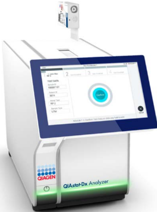
Рисунок 15. Вставлення картриджа до респіраторної панелі QIAstat-Dx аналізу вірусу SARS-CoV-2 в аналізатор QIAstat-Dx Analyzer 1.0.
