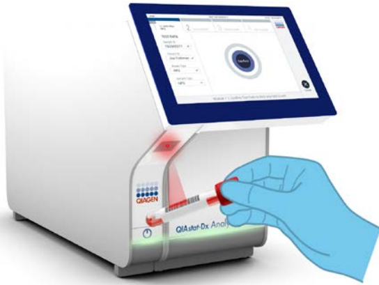
Рисунок 24. Сканування штрих-коду ідентифікатора зразка.
