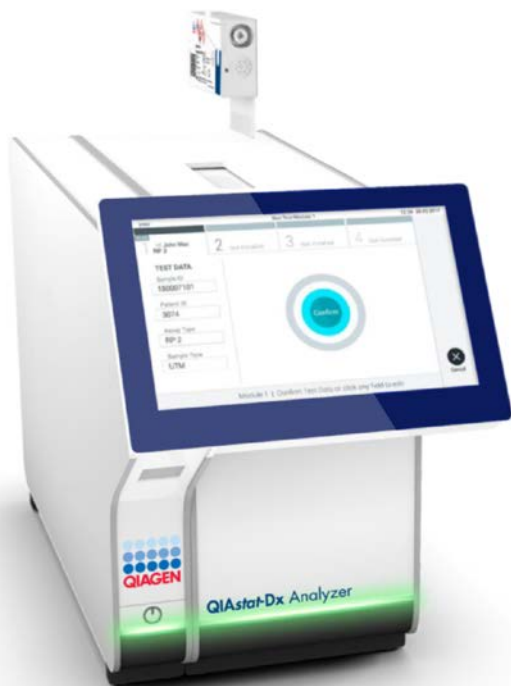
Рисунок 28. Вставлення картриджа до респіраторної панелі QIAstat-Dx аналізу вірусу SARS-CoV-2 в аналізатор QIAstat-Dx Analyzer 1.0.
