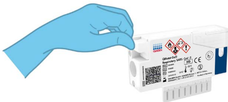
Рисунок 10. Закриття кришки порту для тампону.
