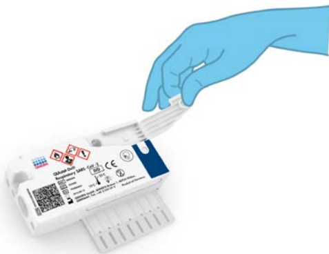
Рисунок 19. Відкриття кришки головного порту для зразка.
