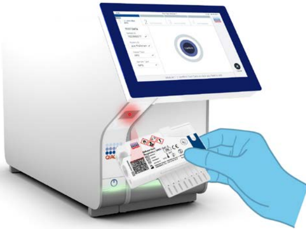
Рисунок 12. Сканування штрих-коду картриджа до респіраторної панелі QIAstat-Dx аналізу вірусу SARS-CoV-2.
