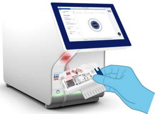
Рисунок 25. Сканування штрих-коду картриджа до респіраторної панелі QIAstat-Dx аналізу вірусу SARS-CoV-2.
