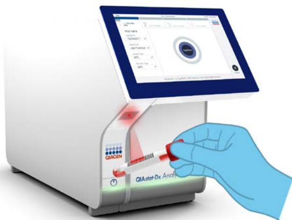
Рисунок 11. Сканування штрих-коду ідентифікатора зразка.
