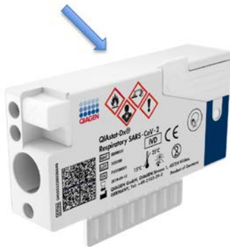
Figura 6. Colocación de los datos de la muestra en la parte superior del QIAstat-Dx Respiratory SARS-CoV-2 Panel Cartridge.
