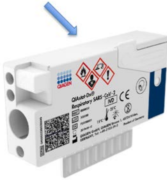
Figura 18. Colocación de los datos de la muestra en la parte superior del QIAstat-Dx Respiratory SARS-CoV-2 Panel Cartridge.
