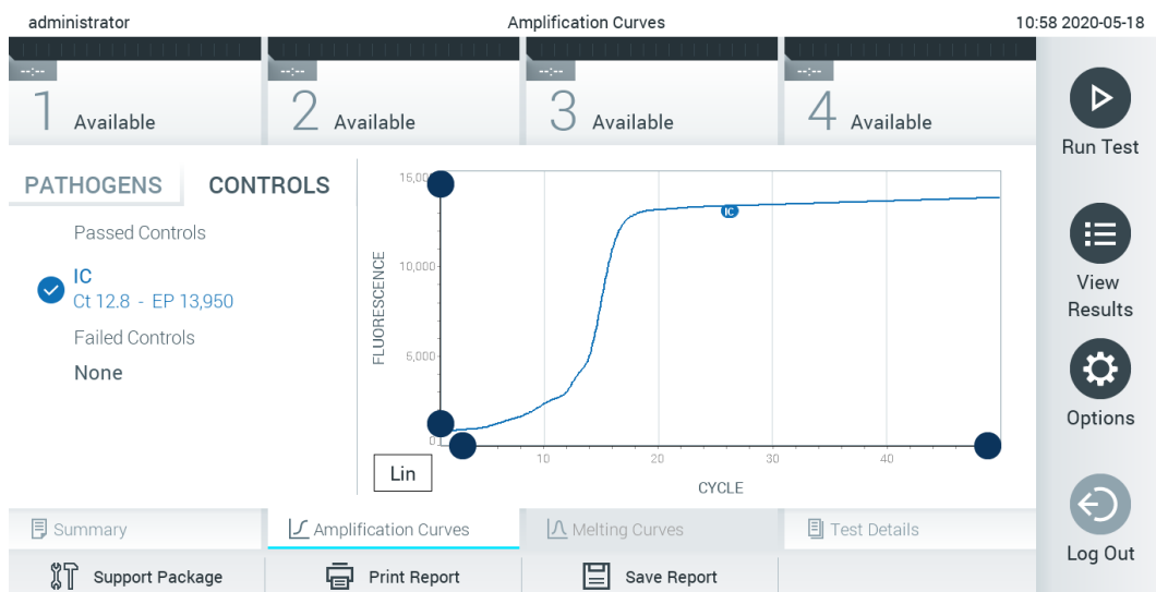
Obrázek 35. Obrazovka Amplification Curves (Amplifikační křivky) (záložka CONTROLS (Kontroly)) zobrazující interní kontroly.
