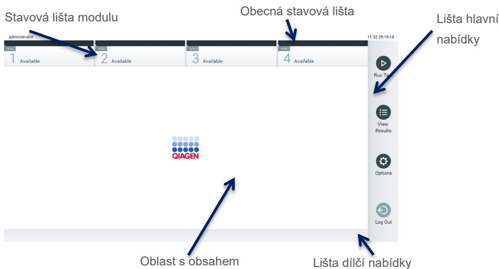
Obrázek 41. Hlavní obrazovka dotykové obrazovky přístroje QIAstat-Dx Analyzer 1.0.
