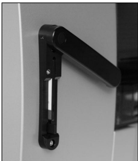
Figura 2. Cartão totalmente inserido na ranhura do cartão EZ1.
