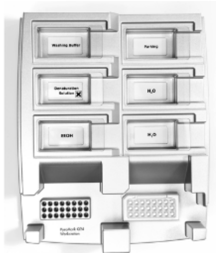
Afbeelding 2. Plaatsing van de PCR-plaat (of -strips) en de PyroMark Q24 Plate op het vacuümwerkstation.
