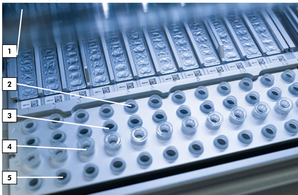
Figura 5. Masa de lucru a instrumentului EZ2 Connect MDx. (1) Bloc de încălzire cu eprubete (ST) de 2 ml încărcate în cartușele cu reactivi (RCV) pentru liză. (2) Eprubete cu probe (ST) (2 ml) încărcate pe rândul A. (3) Eprubetă (ET) (1,5 ml), care conține ARN de transport (CARRIER) și substanță de control internă (internal control, IC) (dacă este utilizată) în soluție tampon de eluție (AVE), încărcată pe rândul B. (4) Stative pentru vârfuri de unică folosință (DTH), care conțin vârfuri cu filtru de unică folosință (DFT) încărcate pe rândul C. (5) Eprubete pentru eluție (ET) (1,5 ml) încărcate pe rândul D.
