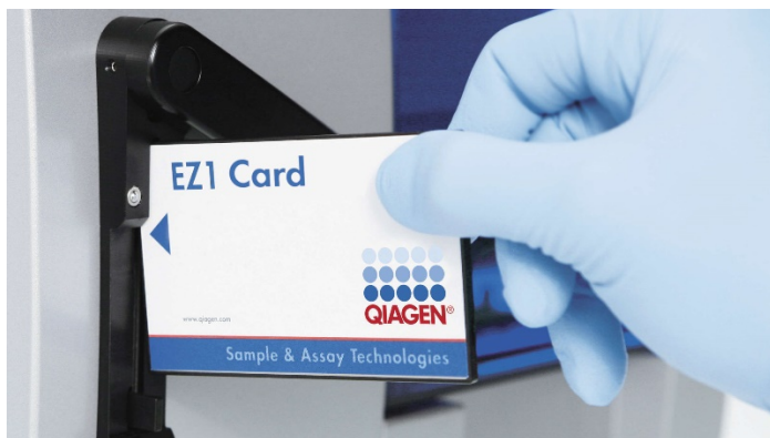
Figura 6. Simplitatea configurării protocolului, utilizând EZ1 DSP Cards. Introducerea unui EZ1 Card, programată în prealabil cu protocolul, în instrumentul EZ1.
