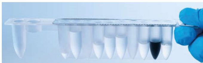
Figura 8. Cartuș cu reactivi (RCV). Un RCV pre-încărcat și sigilat din kitul EZ1 DSP Virus Kit.
