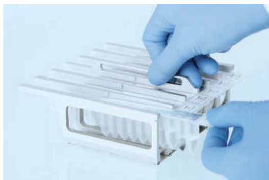
Figura 9. Încărcarea stativului pentru cartușe cu reactivi. Stativul pentru cartușe este etichetat cu o săgeată pentru a indica direcția în care trebuie încărcate cartușele cu reactivi (RCV).
