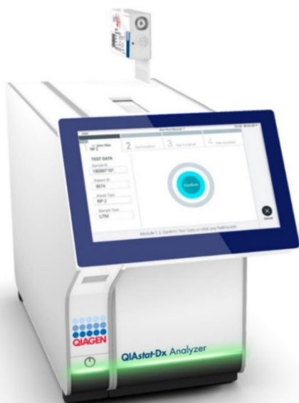
48 pav. „QIAstat-Dx Respiratory SARS-CoV-2 Panel Cartridge“ kasetė įstatoma į „QIAstat-Dx Analyzer 1.0“ arba „QIAstat-Dx Analyzer 2.0“.
