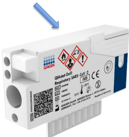
6 pav. Mėginio informacijos uždėjimas ant „QIAstat-Dx Respiratory SARS-CoV-2 Panel Cartridge“ viršaus.
