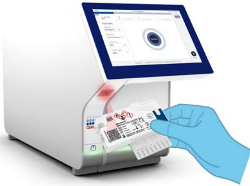
ภาพที่ 25 การสแกนบาร์โค้ดของ QIAstat-Dx SARS-CoV-2/Flu A/B/RSV Panel Cartridge
