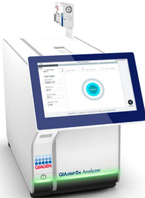
ภาพที่ 15 การใส่ QIAstat-Dx SARS-CoV-2/Flu A/B/RSV Panel Cartridge เข้าสู่ QIAstat-Dx Analyzer 1.0
