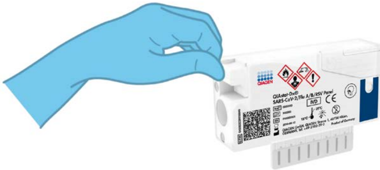
ภาพที่ 10 การปิดฝาตัวอย่างของพอร์ด swab
