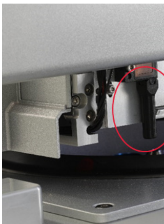
Czarny kolimator wiązki (zaznaczony czerwonym okręgiem) czujnika ultradźwiękowego.
