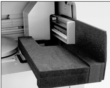
Pianka ochronna umieszczona pomiędzy wirówką a ramieniem robota.
