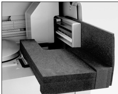
Pianka ochronna ramienia robota.
