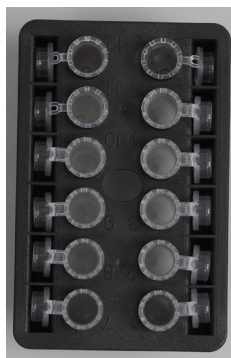
Wieczka próbek należy wcisnąć do szczelin znajdujących się przy krawędziach statywu wytrząsarki
