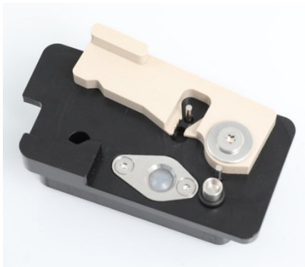
Narzędzie do wymiany O-ringów z przygotowanym nowym O-ringiem.
