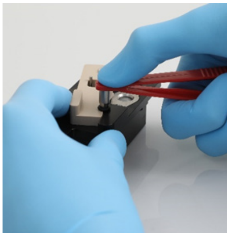
Dociskanie kołka tylnym końcem pęsety.
