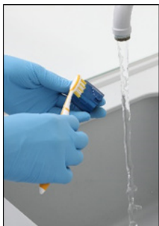
Czyszczenie kosza szczoteczką.
