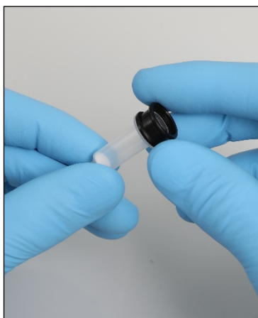
Mocowanie pierścieniowego adaptera kolumny wirówkowej.
