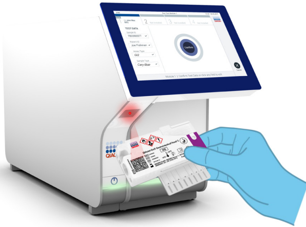
Figura 11. Lendo o código de barras do QIAstat-Dx Gastrointestinal Panel 2 Cartridge.
