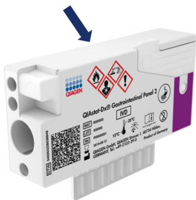
Figura 3. Posicionamento das informações da amostra na parte superior do QIAstat-Dx Gastrointestinal Panel 2 Cartridge.
