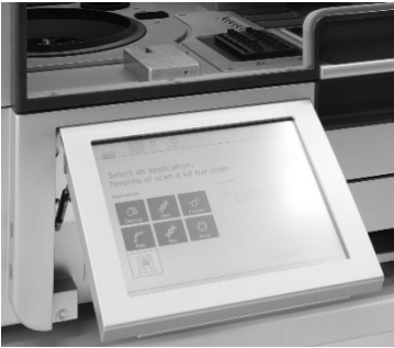
Εικόνα 16: Πτυσσόμενη οθόνη αφής του QIAcube Connect MDx.
