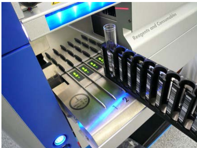
Wsuvanie nośnika probówek w odpowiednie gniazdo.
