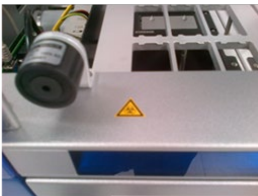
† Pozycja etykiety z ostrzeżeniem o zagrożeniu biologicznym na stole roboczym, w pobliżu magnetycznej blokady pokrywy (AS).
