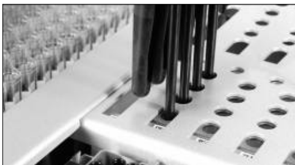
Ośłony końcówek zapobiegają zanieczyszczeniu krzyżowemu.
