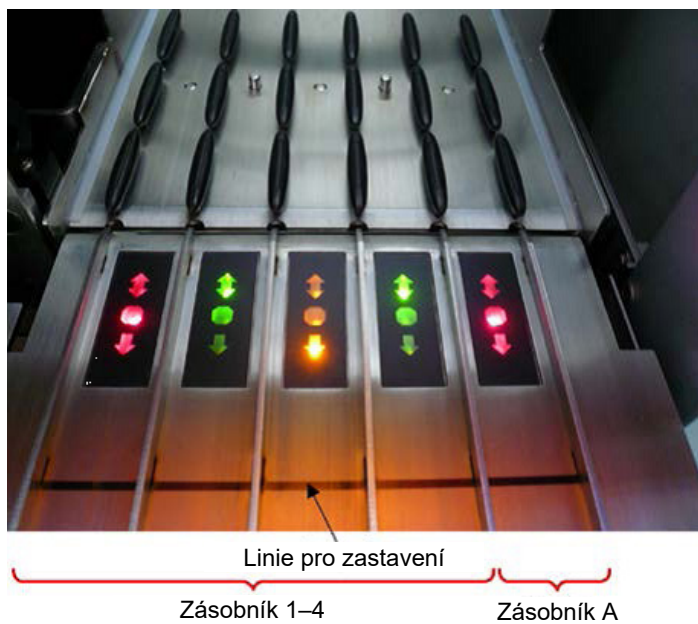
Příklady svítících kontrolky LED stavu zásobníku.
