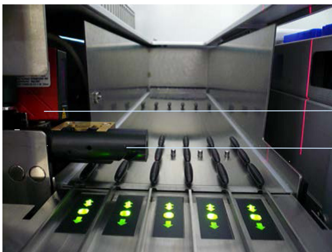
Polohy čtečky čárových kódů a distanční vložky.
