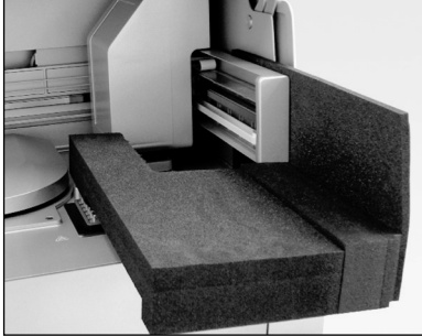
원심분리기와 로봇 암 사이에 삽입된 폼 보호재.
