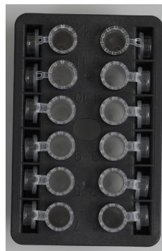
Penutup tabung sampel harus ditempatkan dengan aman dalam slot di bagian tepi rak pengocok
