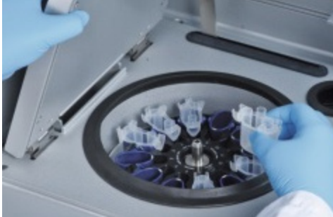
Mengeluarkan adaptor rotor.
