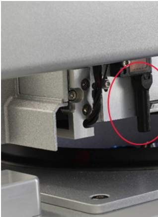
Kolimator sinar hitam (lihat lingkaran merah) pada sensor ultrasonik.
