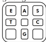
Abbildung 1. Grafische Darstellung der PyroMark Q24 Kartusche in der Draufsicht. Pipettieren Sie das Enzymgemisch (E), das Substratgemisch (S) und die Nukleotide (A, T, C, G) gemäß den Volumenangaben im Informationsbericht vor dem Lauf (ist im Menü „Tools“ beim Einrichten des Laufs erhältlich) in die Kartusche.
