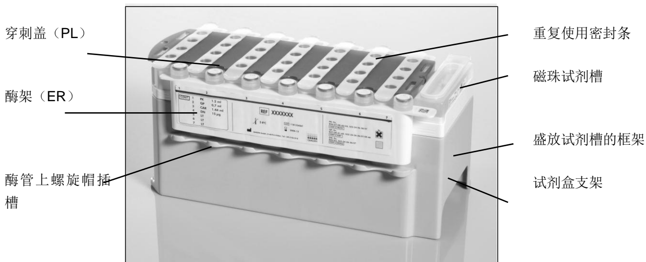
图2 QIAasymphony试剂卡夹（RC）。该试剂卡夹（RC）含有方案运行所需的所有试剂。
