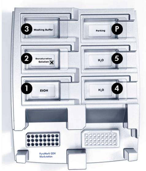
Şekil 3. PCR plakasının ve PyroMark Q24 plakasının vakum istasyonundaki konumu.
