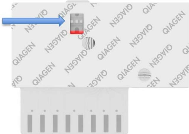
Рис. 23. Окно проверки пробы (синяя стрелка).
