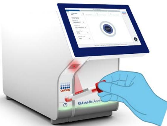
Рис. 11. Сканирование идентификационного штрих-кода пробы.
