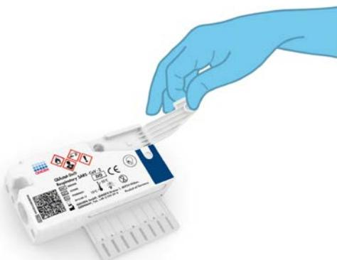
Рис. 19. Открывание крышки отсека для проб основного порта.
