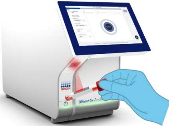
Рис. 24. Сканирование идентификационного штрих-кода пробы.
