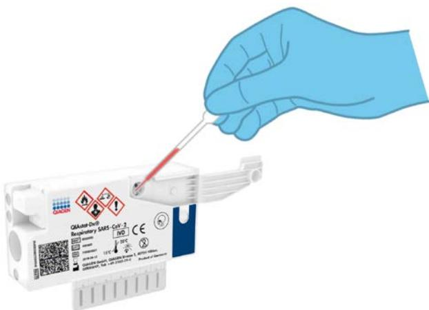
Рис. 21. Перенос пробы в основной порт QIAstat-Dx Respiratory SARS-CoV-2 Panel Cartridge.
