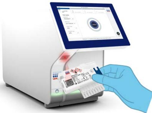
Рис. 25. Сканирование штрих-кода на QIAstat-Dx Respiratory SARS-CoV-2 Panel Cartridge.
