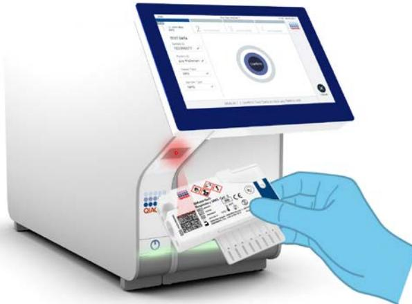
Рис. 12. Сканирование штрих-кода на QIAstat-Dx Respiratory SARS-CoV-2 Panel Cartridge.
