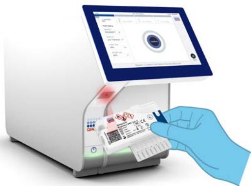
Figura 25. Lendo o código de barras do QIAstat-Dx Respiratory SARS-CoV-2 Panel Cartridge.
