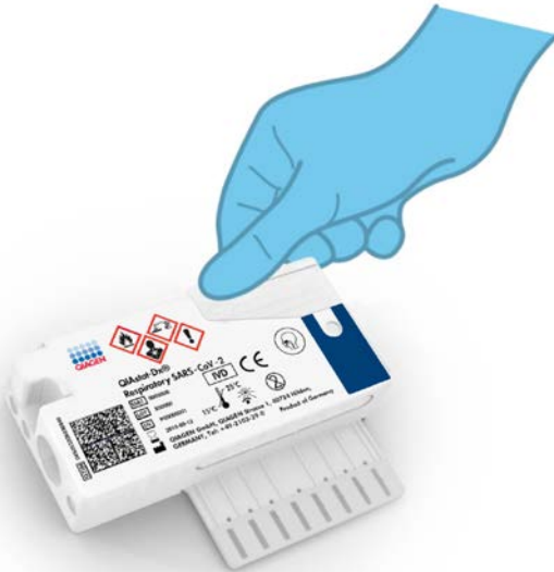
Figura 22. Fechando a tampa de amostra da porta principal.
