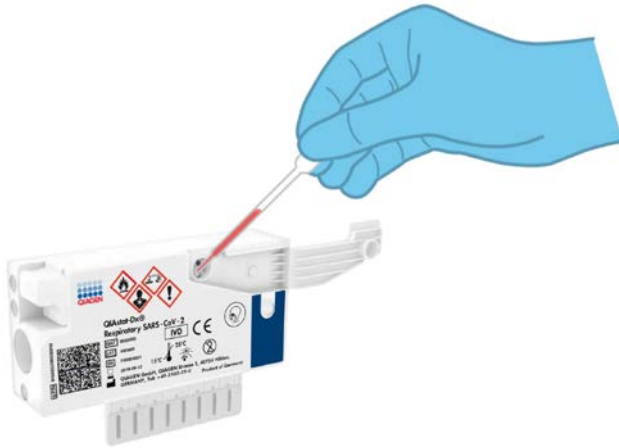
Figura 21. Transferindo a amostra para a porta principal do QIAstat-Dx Respiratory SARS-CoV-2 Panel Cartridge.
