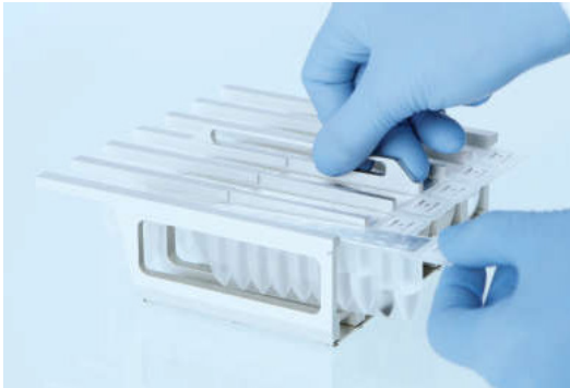
Hình 9. Nạp giá đỡ hộp thuốc thử. Bản thân giá đỡ hộp thuốc thử được dán một mũi tên để chỉ hướng phải nạp hộp thuốc thử (RCV).
