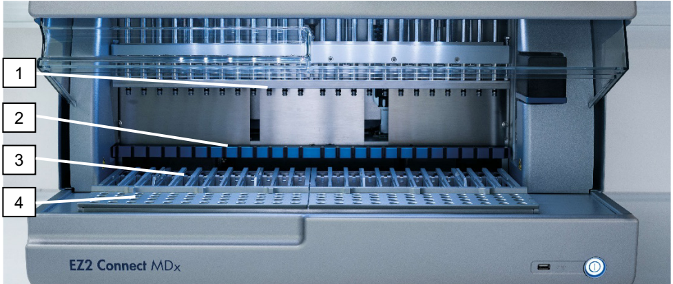
Hình 4. Tổng quan về dụng cụ EZ2 Connect MDx. (1) Đầu pipet, (2) mô-đun nam châm, (3) giá đỡ hộp thuốc thử và (4) giá đỡ đầu tip (giá đỡ dụng cụ phòng thí nghiệm).
