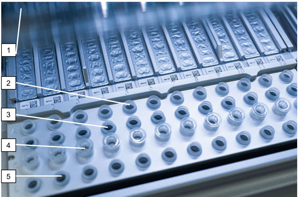
Hình 5. Bàn làm việc của dụng cụ EZ2 Connect MDx. (1) Khối gia nhiệt với các ống 2 mL (ST) được nạp vào hộp thuốc thử (RCV) để ly giải. (2) Ống mẫu (ST) (2 mL) được nạp vào hàng A. (3) Ống (ET) (1,5 mL) chứa RNA chất mang (CARRIER) và mẫu chứng nội (Internal Control, IC) (nếu được sử dụng) trong chất đệm rửa giải (AVE), được nạp vào hàng B. (4) Giá đựng đầu tip dùng một lần (DTH) chứa đầu tip bộ lọc dùng một lần (DFT) được nạp vào hàng C. (5) Ống rửa giải (ET) (1,5 mL) được nạp vào hàng D.
