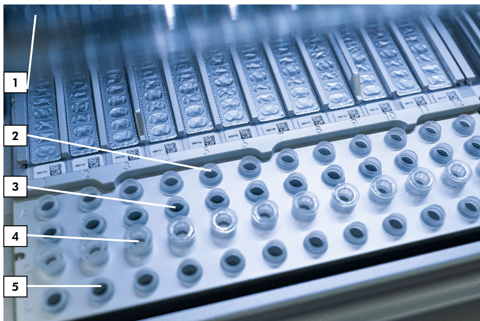
Figura 5. Mesa de trabalho de um instrumento EZ2 Connect MDx. (1) Bloco de aquecimento com tubos (ST) de 2 ml carregados nos cartuchos de reagentes (RCV) para lise. (2) Tubos de amostra (ST) (2 ml) carregados na linha A. (3) Tubo (ET) (1,5 ml) contendo RNA carregador (CARRIER) e controle interno (Internal Control, IC) (se usado) no tampão de eluição (AVE), carregados na linha B. (4) Suportes de ponteiros descartáveis (DTH) contendo ponteiros com filtro descartáveis (DFT) carregados na linha C (5) Tubos de eluição (ET) (1,5 ml) carregados na linha D.
