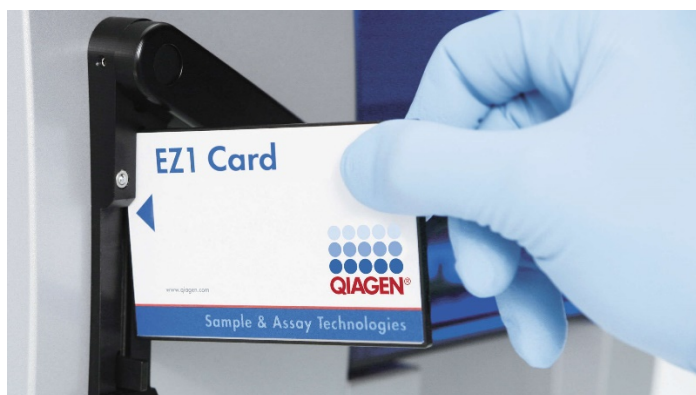
Figura 6. Configuração simples do protocolo usando os EZ1 DSP Cards. Inserção de um EZ1 Card, pré-programado com o protocolo, no instrumento EZ1.
