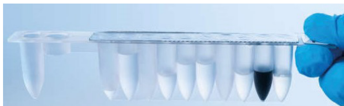
Figura 2. Cartucho de reagentes (RCV). Cartucho de reagentes (RCV) selado e previamente preenchido do EZ1 DSP Virus Kit.
