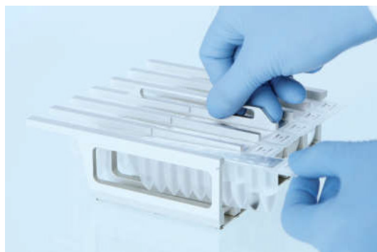
Figura 9. Carregando o rack de cartuchos de reagentes. O rack de cartuchos está sinalizado com uma seta para indicar a direção na qual os cartuchos de reagentes (RCV) devem ser carregados.
