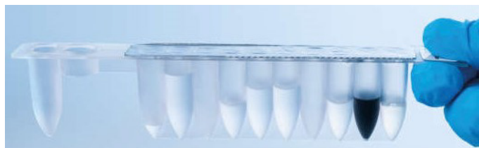
Figura 8. Cartucho de reagentes (RCV). Um RCV selado e previamente preenchido do EZ1 DSP Virus Kit.
