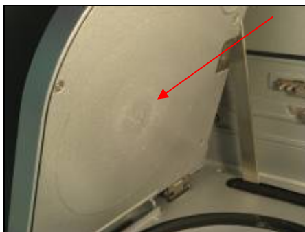
プラスチック粉末が付着した遠心機の蓋
