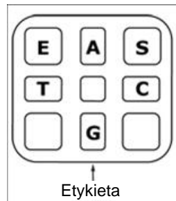
Rysunek 4. Widok kartridża PyroMark Q24 z góry. Widoczne oznaczenia korespondują z oznaczeniami na etykietach odczynników. Dodaj mieszaniny enzymów (E), mieszaniny substratów (S) oraz nukleotydów (A, T, C, G) zgodnie z informacjami zawartymi w raporcie przed-reakcyjnym (pre run information report w menu 'Tools' ustawień reakcji).
