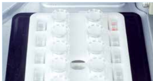
图 2. 全自动的样品裂解。整合的振荡器一次可全自动裂解多达 12 个样品。
