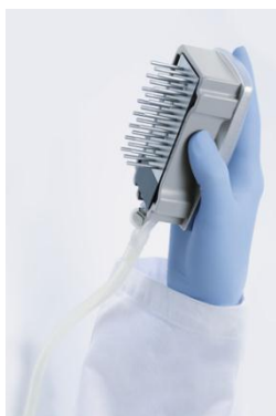
Figura 4. Illustrazione dello strumento del vuoto sollevato di oltre 90° in verticale.
