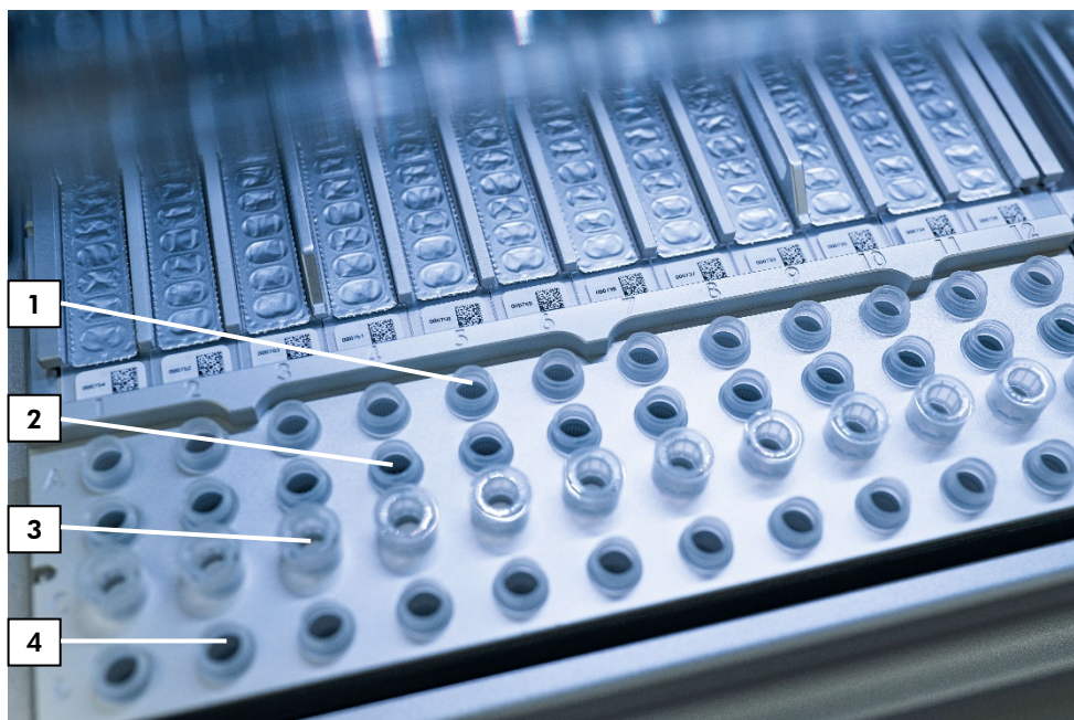
Figura 5. Piano di lavoro strumento EZ2 Connect MDx. (1) Provette di campione (ST) (2 ml) caricate nella fila A. (2) Vuota o opzionale: Provetta (2 ml) contenente etanolo all'80% per la fase di lavaggio opzionale, caricata nella fila B. (3) Porta-puntali monouso (DTH) contenenti puntali con filtro monouso (DFT) caricati nella fila C. (4) Provette di eluizione (ET) (1,5 ml) caricate nella fila D.
