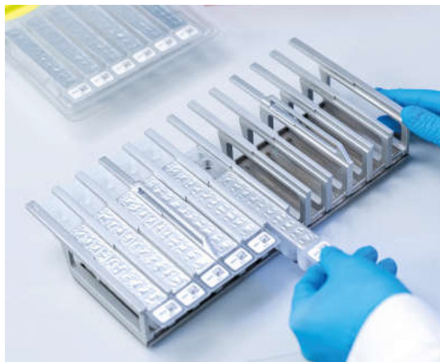
Figura 3. Rack delle cartucce reagenti. Il rack delle cartucce stesso è contrassegnato da una freccia che indica la direzione nella quale devono essere caricate le cartucce reagenti (RCB).
