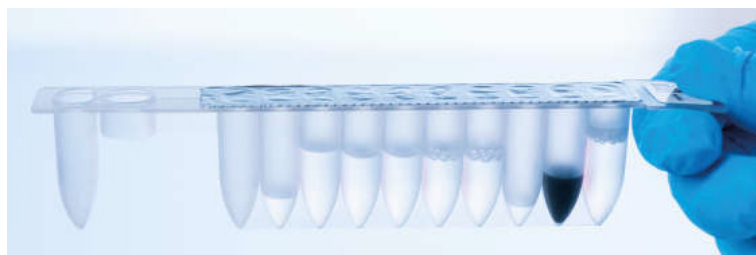
Figura 8. Cartuccia reagenti (RCB). Una RCB sigillata e preriempita di EZ1 DSP DNA Blood Kit.
