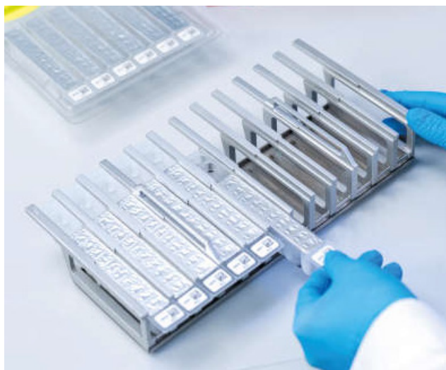
Obrázek 3. Stojánek na kazety s reagensiiemi. Stojánek na kazety je označen šipkou, která označuje směr, ve kterém musejí být kazety s reagensiiemi (RCB) vkládány.
