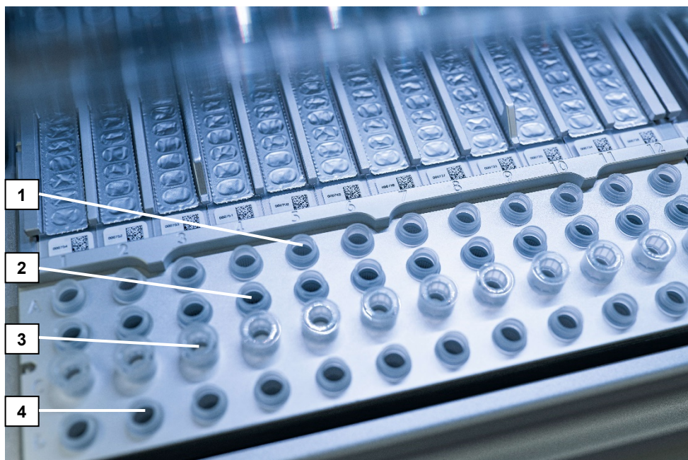
Obrázek 5. Pracovní plocha na přístroji EZ2 Connect MDx. (1) Vzorové zkumavky (Sampe Tube, ST) (2 ml) vložené do řady A. (2) Prázdné nebo volitelné: Zkumavka (2 ml) obsahující 80% etanol pro volitelný krok promývání, vložená do řady B. (3) Držáky jednorázových špiček (DTH) obsahující jednorázové špičky s filtrem (DFT) vložené do řady C. (4) Eluční zkumavky (ET) (1,5 ml) vložené do řady D.
