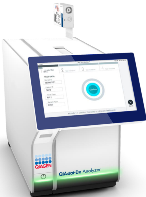
Εικόνα 15. Εισαγωγή φύσιγγας QIAstat-Dx Respiratory SARS-CoV-2 Panel Cartridge στον αναλυτή QIAstat-Dx Analyzer 1.0.
