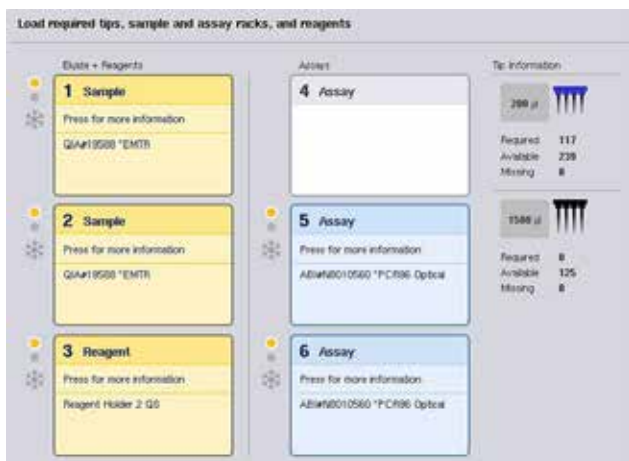
Skjermbildet Lasteinformasjon med analysestativer tilordnes til åpning 5 og 6.
