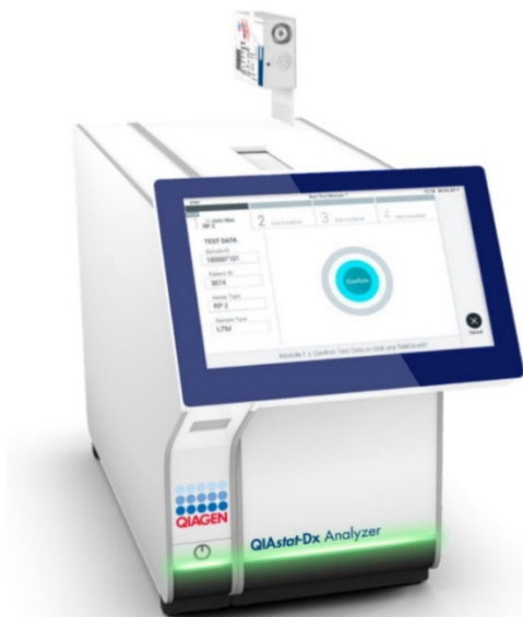
Рисунок 48. Вставлення картриджа до респіраторної панелі КВІАстат-ДКс (QIAstat-Dx) SARS-CoV-2 в аналізатор КВІАстат-ДКс (QIAstat-Dx) 1.0 або КВІАстат-ДКс (QIAstat-Dx) 2.0.
