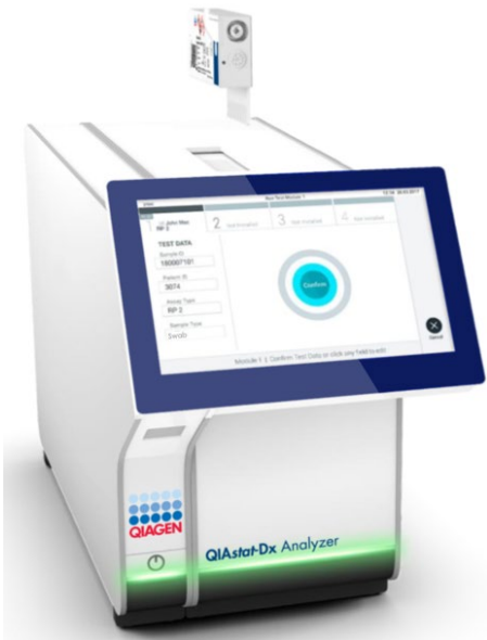
Рисунок 15. Вставлення картриджа до респіраторної панелі КВІАстат-ДКс (QIAstat-Dx) SARS-CoV-2 в аналізатор КВІАстат-ДКс (QIAstat-Dx) 1.0 або КВІАстат-ДКс (QIAstat-Dx) 2.0.
