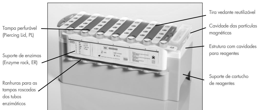
Figura 2. Cartucho de reagentes QIASymphony (reagent cartridge, RC). O cartucho de reagentes (RC) contém todos os reagentes necessários para a execução do protocolo.
